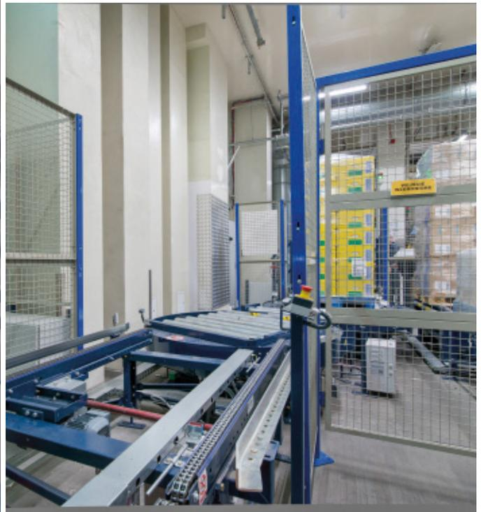
Mecalux a installé un convoyeur chargé de transporter la marchandise directement depuis l'usine de NUTRICIA jusqu'à la zone d'expédition de l'entrepôt. Ce système de transport évite le recours aux engins de manutention traditionnels pour transporter la marchandise entre les deux points. La réduction de la manutention manuelle des chargements accroît considérablement la sécurité de l'installation.
