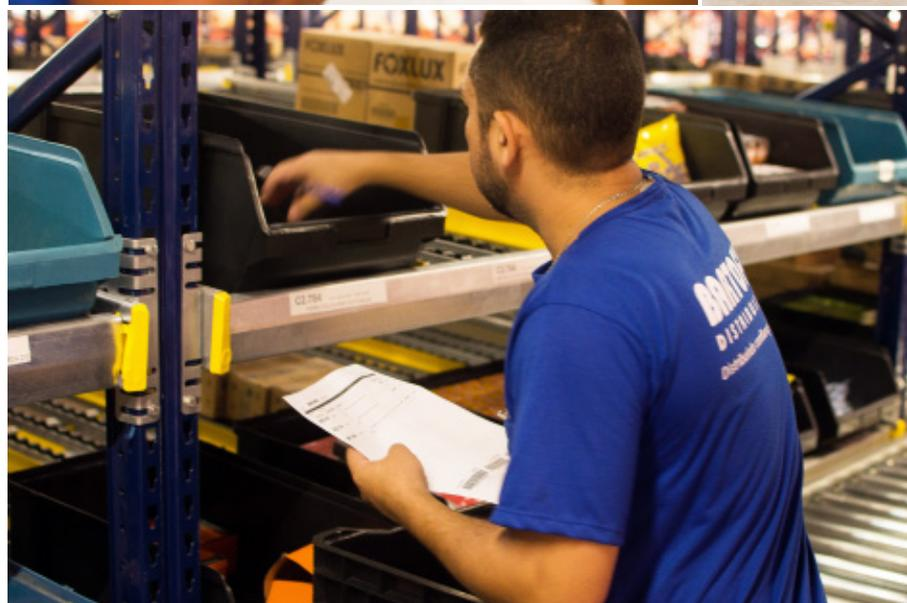
Des rayonnages de picking dynamique sont situés entre les deux blocs de rayonnages dynamiques. Ils sont composés de trois plates-formes équipées de rouleaux et légèrement inclinées pour que les bacs se déplacent sous l'effet de la gravité. L'avantage de ces solutions est qu'il y a toujours du stock disponible lors du picking.
