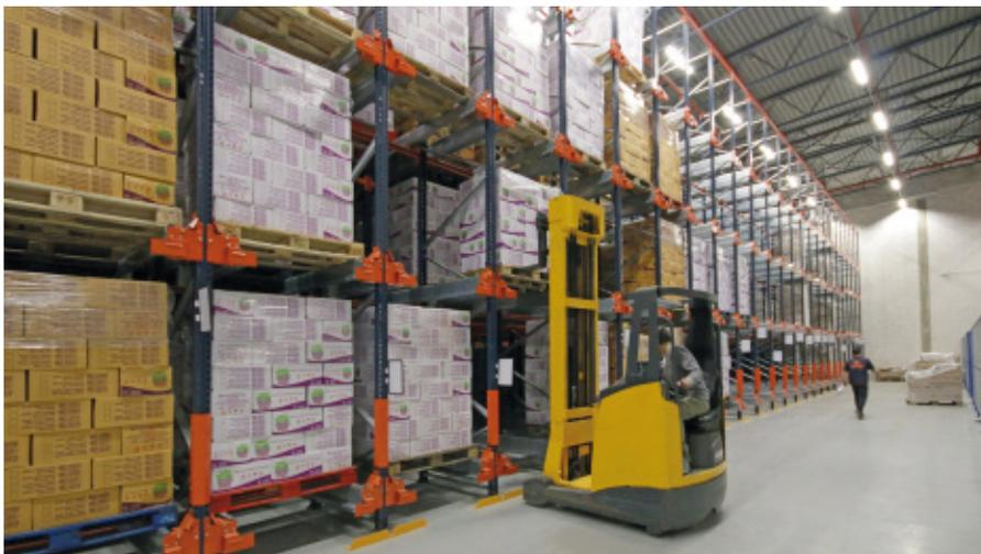
Firat Food, grossiste en denrées alimentaires et boissons, a réorganisé le fonctionnement de son entrepôt en France afin de dynamiser la préparation de commandes. Mecalux a installé les rayonnages à palettes, le système par accumulation Pallet Shuttle et un convoyeur à rouleaux qui relie les différentes zones de l'installation.
